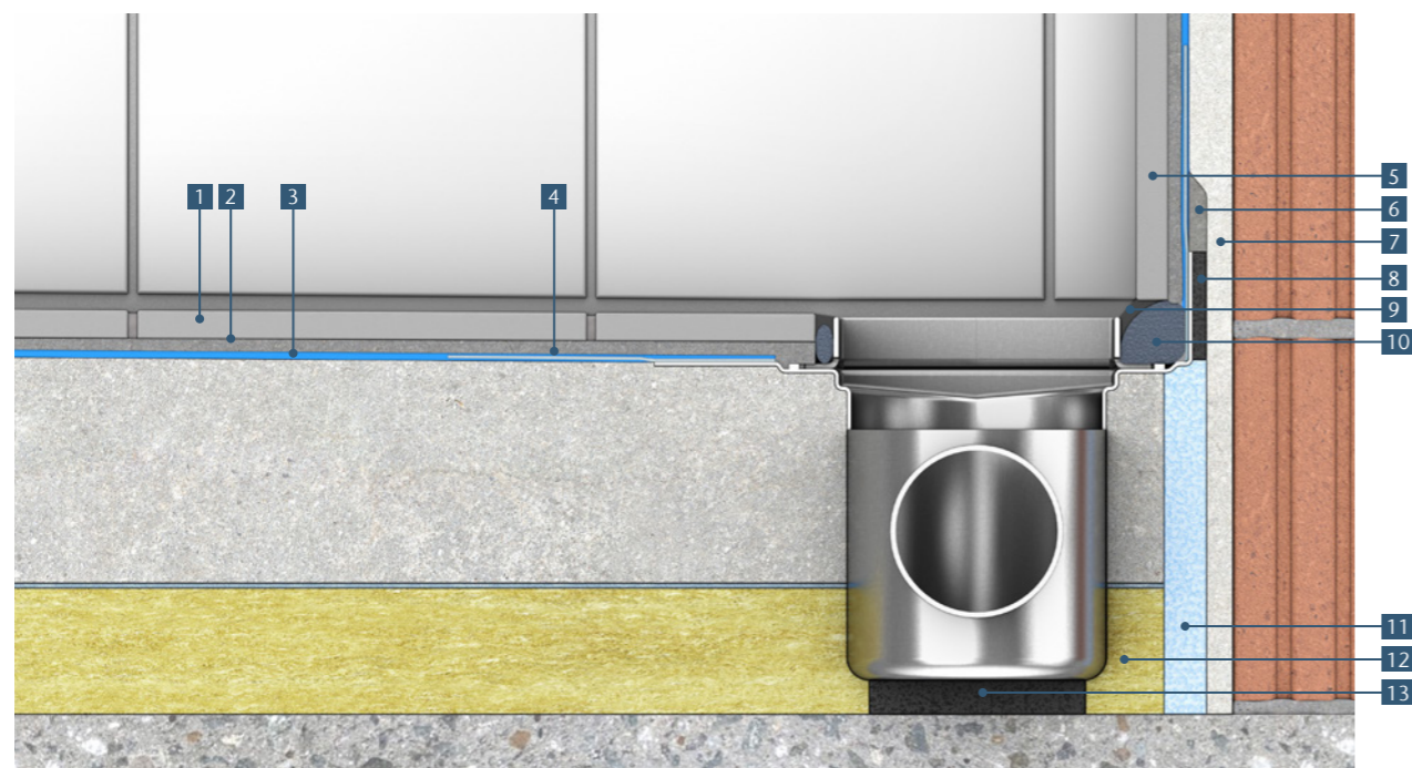
Einbauvorschlag ACO ShowerDrain E+ (Bodenaufbau gemäß Schallschutzprüfbericht)
