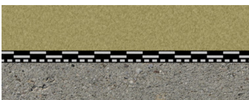
Balkon mit Abdichtungsbahn, Umkehrdach
