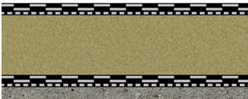
Balkon mit Abdichtungsbahn und Wärmedämmung
