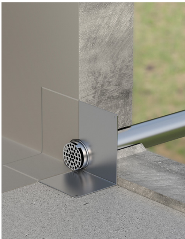
ACO Speier zur Hauptentwässerung – bündig mit der Balkonplatte, abgedichtet mit Flüssigkunststoff
