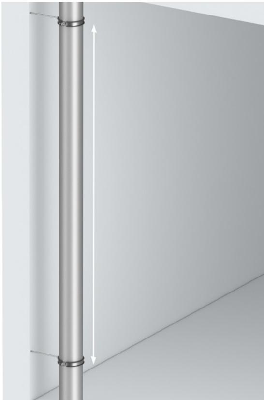
Bei horizontalen Leitungen müssen mindestens zwei Rohrhalter pro 3 Meter angeordnet werden. Die erste Rohrschelle sollte in einem Abstand von max. 30 cm von der Rohrverbindung, und die zweite ungefähr in der Mitte des Rohres, jedoch max. 2 Meter von der nächsten Rohrschelle entfernt sein. Unsere Empfehlung für die Abstände der Rohrbefestigungen bei der Verwendung von ACO Pipe:
