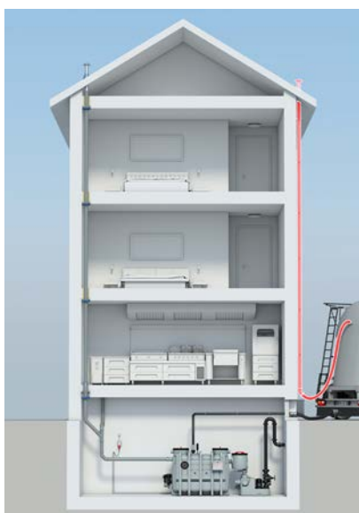
Separate Pendelgasleitung über Dach
