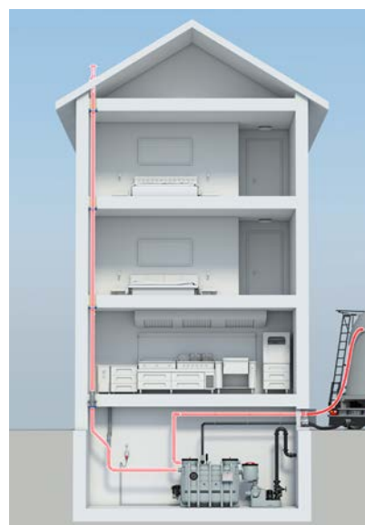
Pendelgasleitung angeschlossen an Fettabscheider
