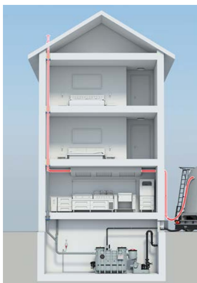
Pendelgasleitung angeschlossen an Lüftungsleitung des Fettabscheiders
