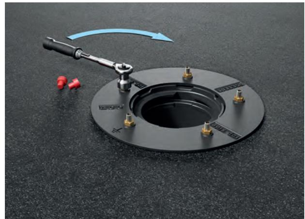
Nach Aufsetzen des Losflanschs müssen die Muttern über Kreuz angezogen werden.
