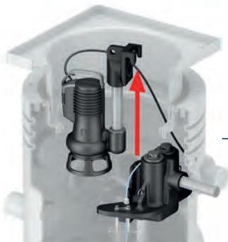
Zur einfachen Montage und Demontage verfügen die Pumpeinheiten über ein kombiniertes Kupplungssystem. Dadurch lassen sich die Pumpen sowohl in Mono- als auch in Duo-Ausführung schnell und werkzeuglos im Behälter montieren.
