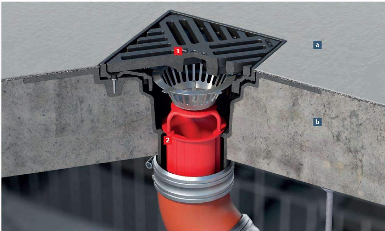
**1** Parkdeckablauf Passavant mit Verschraubung, mit Anschlussrand und Eimer aus Edelstahl, Stutzenneigung 90°, Rahmenmaß 200 x 200 mm Artikel-Nr. 5935.10.02
