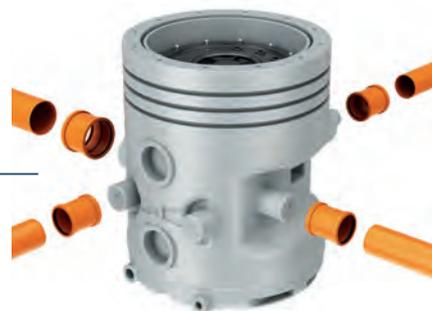
Der Grundkörper gefertigt aus dem robusten Werkstoff Polyethylen besitzt insgesamt sieben verteilte Zuläufe für den Anschluss von Kunststoffrohr mit Außendurchmesser 110 oder 160 mm.
