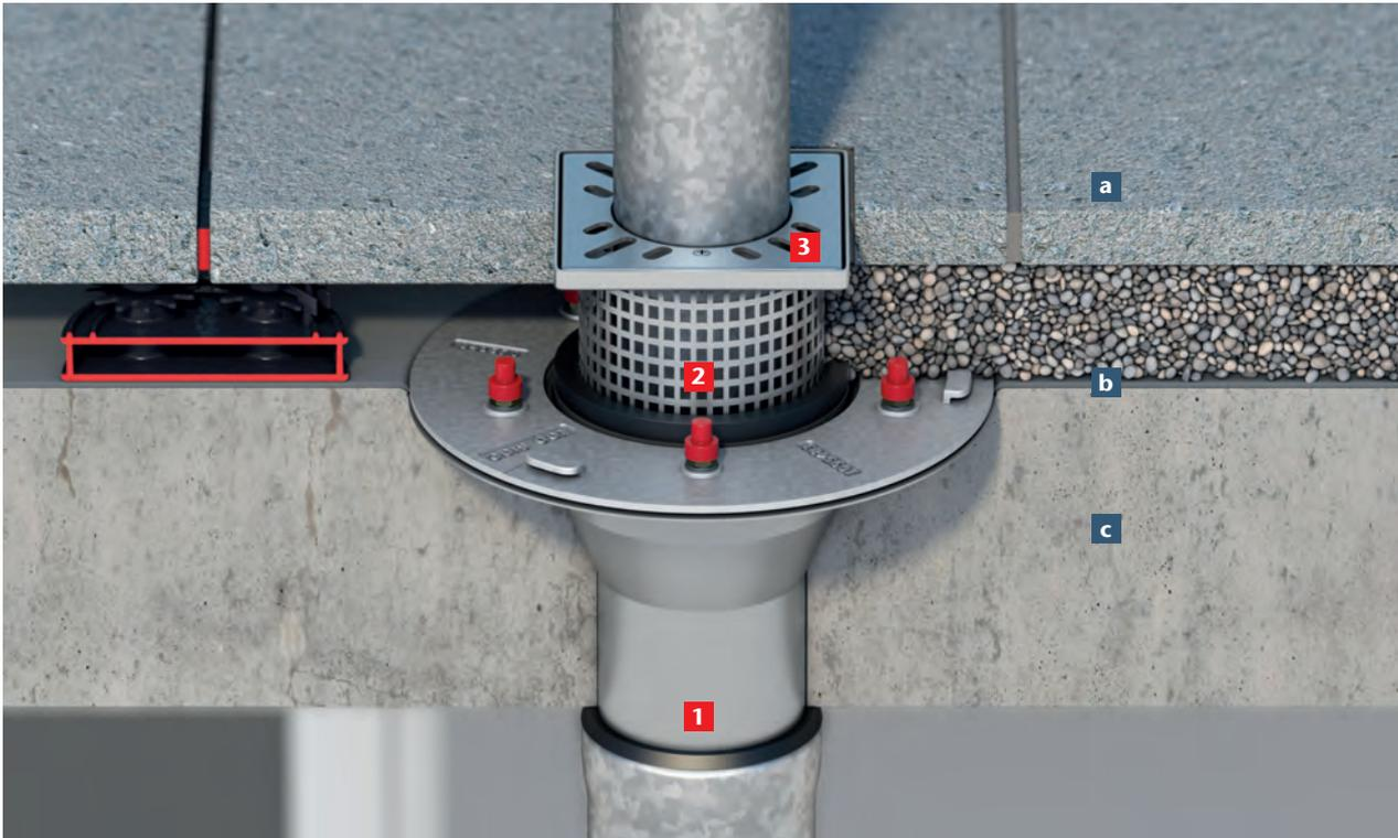
**1** Balkonablauf mit Pressdichtungsflansch DN 70 aus Edelstahl, Stutzenneigung 90°
