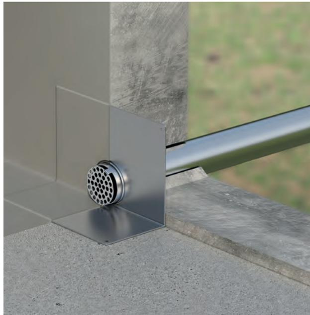
ACO Speier zur Hauptentwässerung – bündig mit der Balkonplatte, abgedichtet mit Flüssigkunststoff
