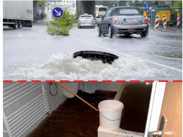
Die Rückstauenebene ist die höchste Ebene, bis zu der das Abwasser in der Entwässerungsanlage ansteigen kann, das ist in der Regel bis zur Straßenoberkante. Ab dieser Höhe verteilt sich rückstauendes Abwasser auf der Oberfläche im Gelände. Die Rückstauenebene ist in der Ortssatzung definiert.
