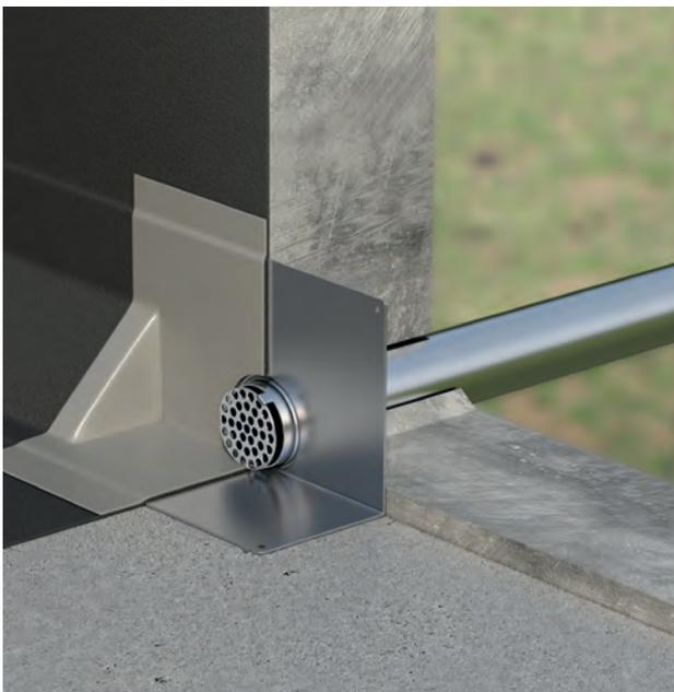
ACO Speier zur Hauptentwässerung – bündig mit der Balkonplatte, abgedichtet mit bituminöser Abdichtungsbahn und Flüssigkunststoff im Bereich des Speiers
