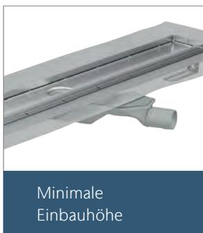
◀ Das Thema Einbauhöhen kommt immer wieder auf Sie zu, nicht nur bei der Sanierung. Mit der ACO ShowerDrain M+ haben Sie eine flexible Lösung zur Hand: So realisieren Sie Einbausituationen von 56 mm - 140 mm bis Oberkante Estrich. Zusätzlich wird Ihnen die Installation durch die Wahl zwischen vier Ablauftopfvarianten erleichtert. Die Höhe können Sie dadurch um bis zu 84 mm variieren.
