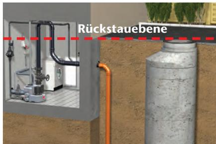
Schutz gegen Rückstau bei Gefälle zum Kanal durch eine Abwasserhebeanlage in Mehrfamilienhäusern, Gewerbeobjekten und Einfamilienhäusern mit Einliegerwohnung
