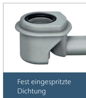
▲ Bei der Installation ist eine dauerhaft dichte Verbindung der Komponenten sehr wichtig: Alle Ablaufkörper der ACO ShowerDrain M+ sind mit einer fest eingespritzten Dichtung ausgestattet. Somit ist ausgeschlossen, dass die Dichtung aus Versehen verloren geht oder diese bei der Montage verrutscht.
