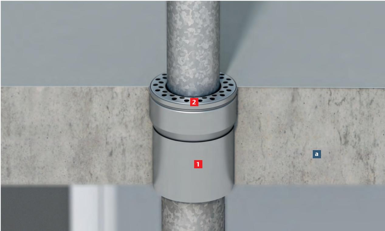
**1** Balkonablauf mit Glocke DN 70 aus Edelstahl für Balkonplattenstärke 180 mm
